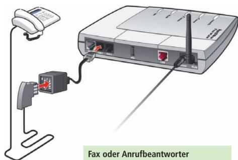
Fax oder Anrufbeantworter schließen Sie an die mit „N“ beschriftete Buchse des dicken Adapterwürfels an.
