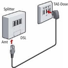
3. Verbinden Sie das grau-schwarze DSL-Telefon-Kombikabel mit der „DSL/Tel“ beschrifteten Buchse Ihres DSL-Modems.
